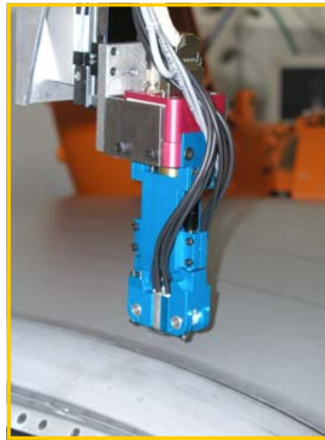
Figure 2 : la tête de capteur, comprenant la caméra CMOS (en rouge), le laser et une source lumineuse (en bleu), contrôle un joint de soudure laser à l'aide d'une raie laser.
