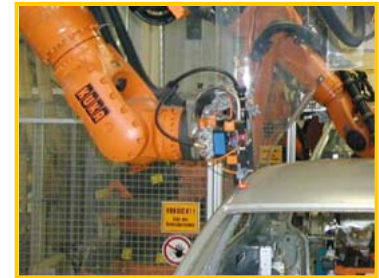
Figure 4 : Figure 3 : un robot équipé d'une tête de capteur CMOS inspecte un joint de soudure laser sur le toit d'une Audi A3
